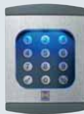
Radiokodlås FCT 10b Radiokodlåset FCT 10b har (utöver funktionerna hos kodlåsen CTR 1b och CTR 3b) följande fördelar: Enkel installation, eftersom inga kablar måste dras, samt upp till 10 fjärrkoder (868,3 MHz) för manövrering av upp till 10 portar.
